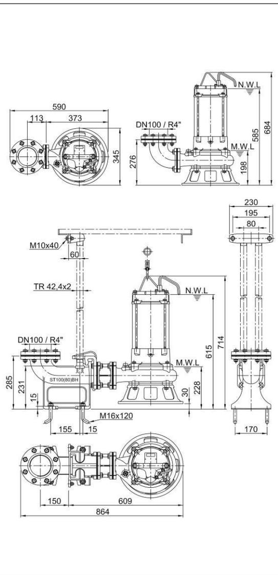
**AUFMERKSAMKEIT!** Ein längerer Betrieb der Pumpe auf dem Mindestniveau (MWL) kann zu einer Überhitzung des Pumpenmotors führen. Für den Dauerbetrieb muss der Motor geflutet werden (NWL).
