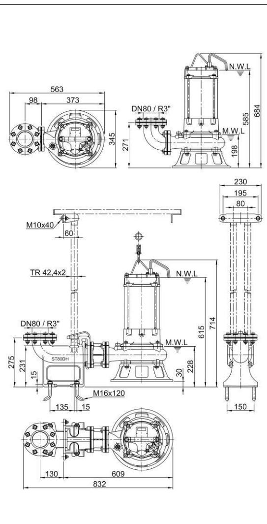
**AUFMERKSAMKEIT!** Ein längerer Betrieb der Pumpe auf dem Mindestniveau (MWL) kann zu einer Überhitzung des Pumpenmotors führen. Für den Dauerbetrieb muss der Motor geflutet werden (NWL).
