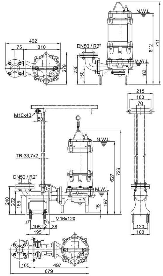
**AUFMERKSAMKEIT!** Ein längerer Betrieb der Pumpe auf dem Mindestniveau (MWL) kann zu einer Überhitzung des Pumpenmotors führen. Für den Dauerbetrieb muss der Motor geflutet werden (NWL).
