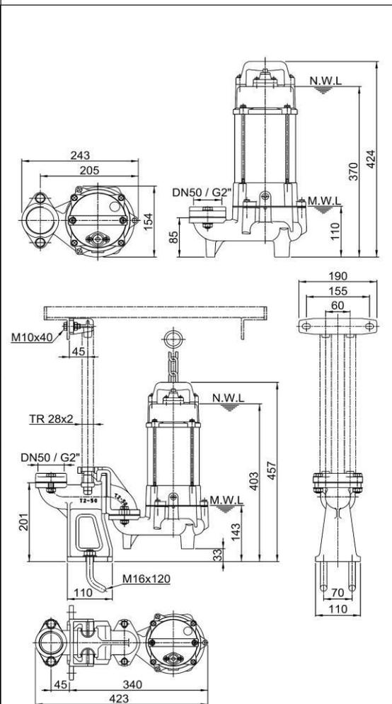
**AUFMERKSAMKEIT!** Ein längerer Betrieb der Pumpe auf dem Mindestniveau (MWL) kann zu einer Überhitzung des Pumpenmotors führen. Für den Dauerbetrieb muss der Motor geflutet werden (NWL).
